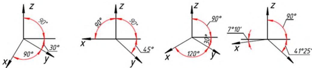
28 Координатные оси в прямоугольной диметрии располагаются относительно друг друга
