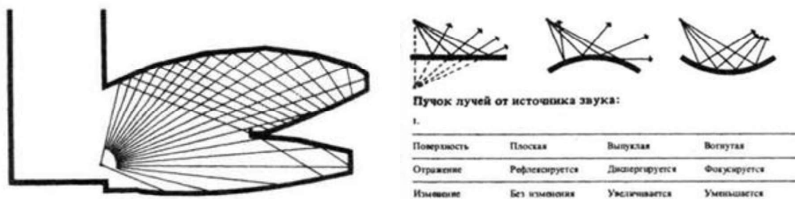
Рис.7. Применение геометрической акустики при проектировании формы зала
