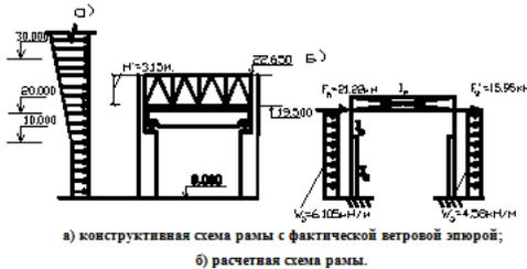
Рис.2.4. К определению ветровых нагрузок (нагружение № 3)
