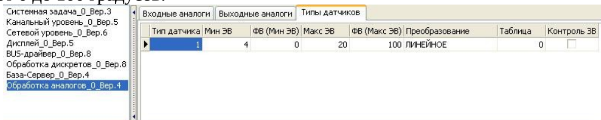
Рисунок 42 – Пример заполнения вкладки «Типы датчиков».
