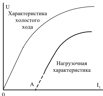
Рисунок 12.3 - Индукционная нагрузочная характеристика синхронного генератора
