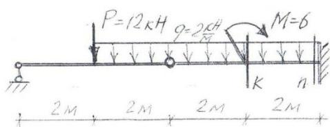
Определить поперечную силу в сечении «к» и изгибающий момент в сечении «п»
