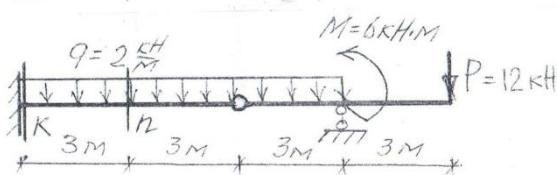
Определить поперечную силу в сечении «к» и изгибающий момент в сечении «п»
