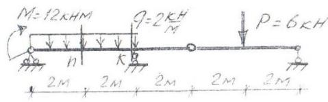
Определить поперечную силу в сечении «п» и изгибающий момент в сечении «к»
