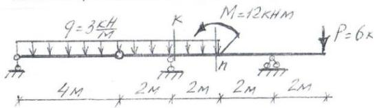
Определить поперечную силу в сечении «к» и изгибающий момент в сечении «п»
