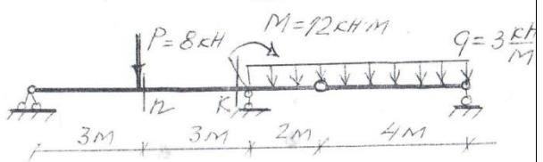
Определить поперечную силу в сечении «к» и изгибающий момент в сечении «п»
