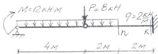
Определить поперечную силу в сечении «п» и изгибающий момент в сечении «к»
