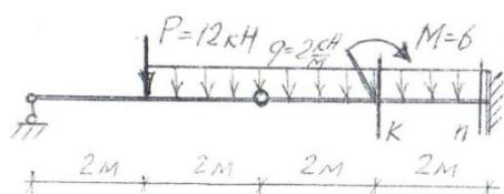
Определить поперечную силу в сечении «п» и изгибающий момент в сечении «к»
