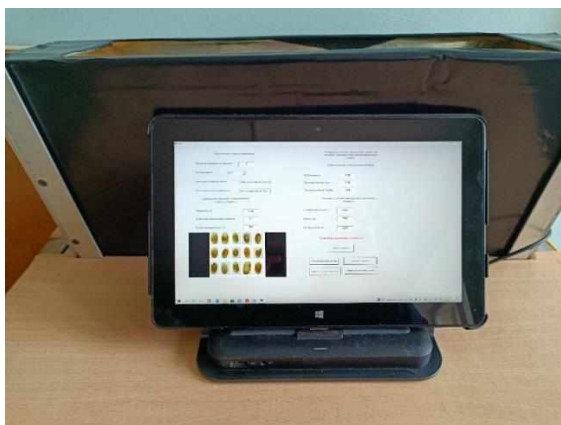
Рисунок 3.9. Изображение панели управления оптико-электронной установкой для анализа и сортировки семян
