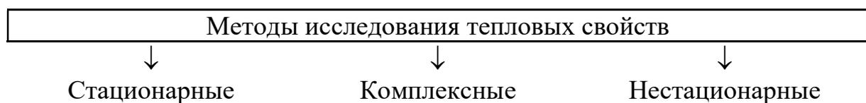
Большинство экспериментальных методов основывается на наблюдении за температурным полем в исследуемом теле при нагревании (охлаждении). Применительно к стационарным условиям используют закон Фурье
