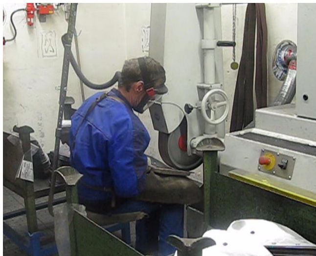
Рисунок 2.7 – Ручная шлифовка отвалов плуга
