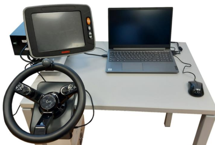
Рисунок 1 – Демонстрационный стенд системы рулевого управления
