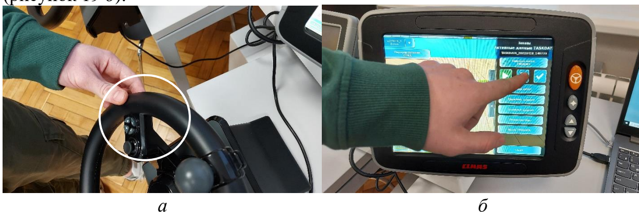
Рисунок 19 – Выбор: а – нажатие клавиши включения Cruise control ; б – отключение текущего заказа
